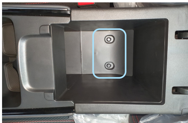
Фото 1.6. Болты крепления центрального тоннеля в подлокотнике
